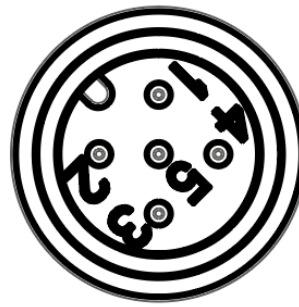
M12 5-polig Code A Stecker, Ansicht der Display-Pins
