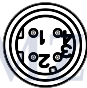
M12 4-polig Code D Stecker, Ansicht der Display-Pins
